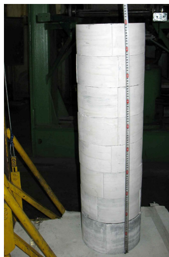
Рис. 6. Кольца жаровой трубы горелки для сжигания угольной аэросмеси из УВТК ZrB_2-SiC-ZrSi_2
