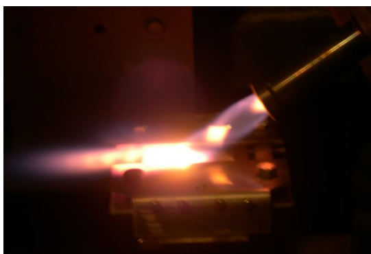
Рис. 5. Испытания УВТК при угле натекания 30°
