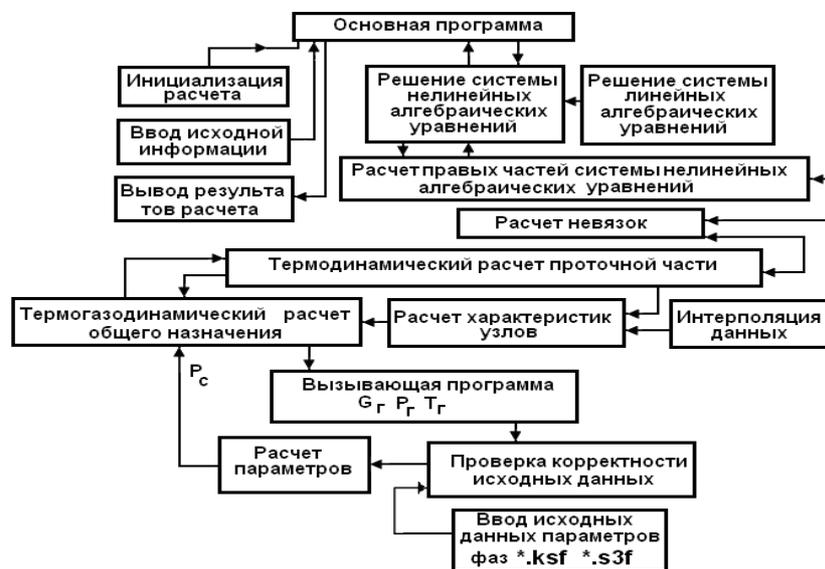
Рис. 4. Структура программы, реализующей совместную математическую модель ГТД – трехфазное сопло
