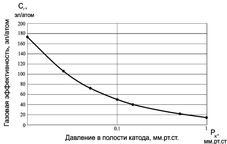
Рис. 2. Зависимость газовой эффективности полого катода от давления в его полости
