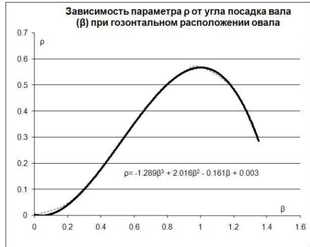
Рис. 5. Зависимость параметра \rho от места посадки вала ротора на опоре \beta
