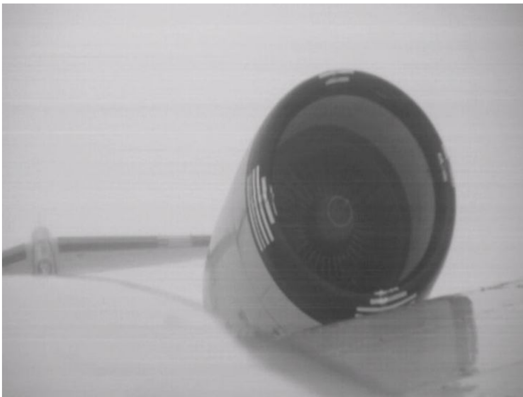
Рис. 1. Возникновение обледенения на коке двигателя
