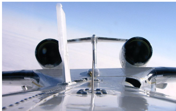
Рис. 5. Возникновение обледенения на центроплане самолета БЕ-200ЧС
