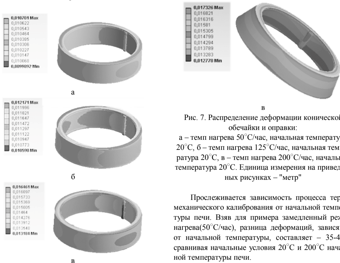
Рис. 6. Распределение деформации цилиндрической обечайки и оправки при темпе нагрева 125°С/час и начальных условиях 20°С(а), 100°С(б) и 200°С(в). Единица измерения на приведенных рисунках - "метр"
