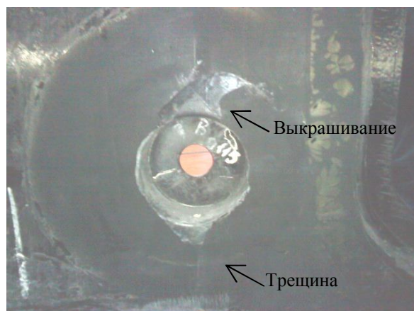
Рис. 5. Трещины и зоны выкрашивания гелькоута треугольной формы размерами 35x25 мм
