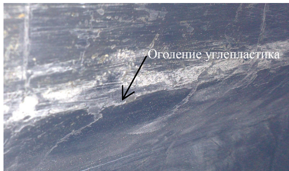
Рис. 6. Раковины в связующем с оголением углепластика на радиусе перехода законцовки верхнего шпангоута на внутреннюю поверхность оболочки
