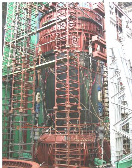
Рис. 2. Общий вид сборки МСО РН «Циклон-4» при проведении испытаний
