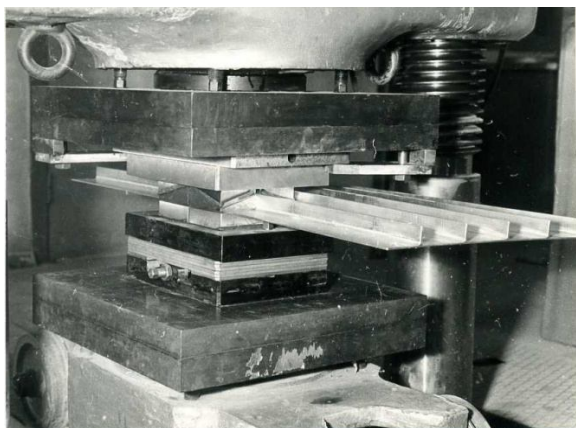
Рис. 3. Рабочий момент деформирования панели в прессе с использованием специального штампа
