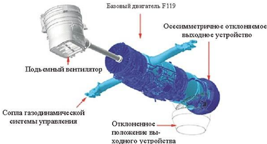
Рис. 6. Комбинированная СУ с ТРДДФ F 119, выносным вентилятором и поворотным на 90° соплом
