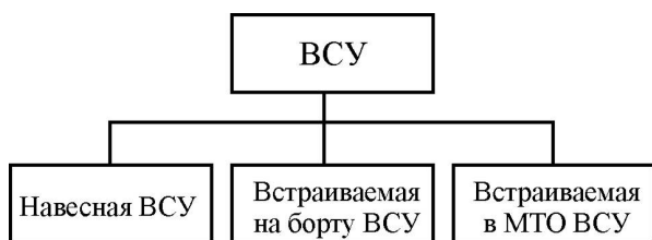
Рис. 1. Способы установки вспомогательной силовой установки на транспортном средстве
