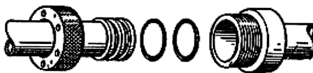
Рис. 3. Соединение с двумя радиальными уплотнительными резиновыми кольцами
