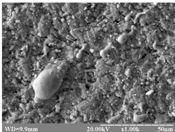
Рис. 7. Пленка на керамике, полученная в источнике с катодом из титана
