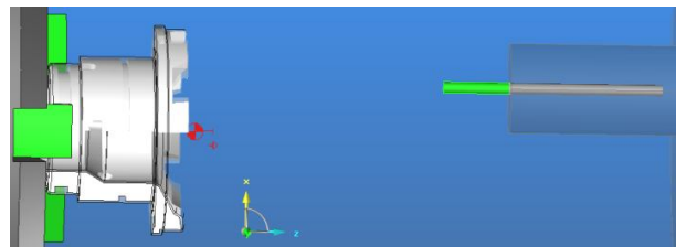
Рис. 11. Перемещение фрезы в положение параллельности оси с осью Z-
