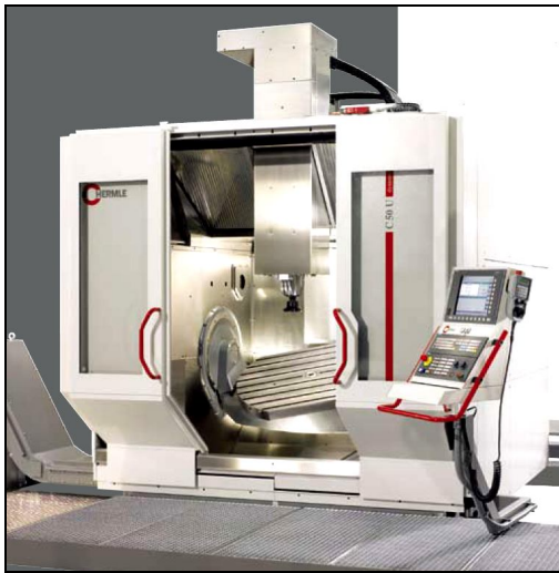
Рис. 4. 5-ти координатный высокоскоростной обрабатывающий центр C50U фирмы HERMLE
