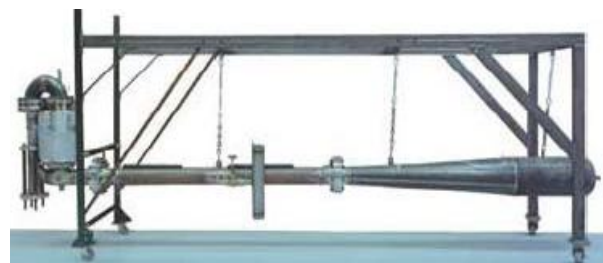
Рис. 1. Примеры термоакустических тепловых машин: а – ТАР системы охлаждения фрегата ВМФ США; б – термоакустический электрогенератор проект - Space Shuttle; в – термоакустический двигатель Стирлинга [1]
