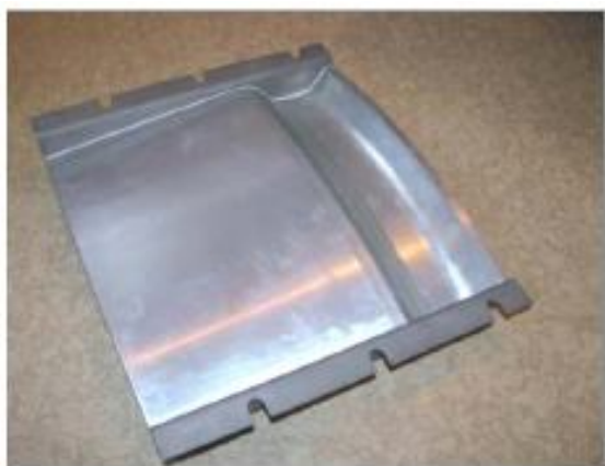
Рис. 1. Общий вид образцов корпуса вентилятора для огневых инженерных испытаний: а – образец с акустической панелью; б – образец с прирабатываемым покрытием
