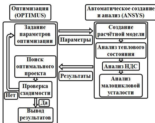
Рис. 1. Схема взаимодействия ANSYS и LMS OPTIMUS
