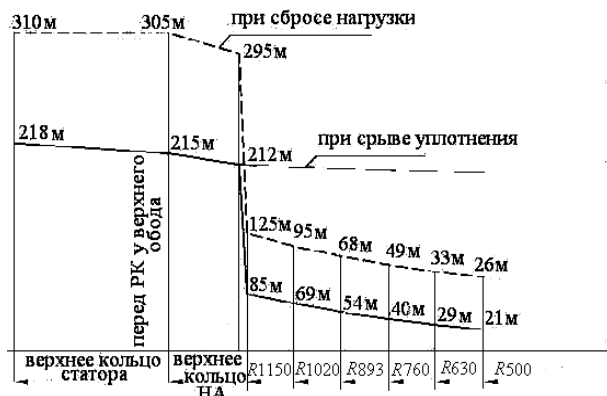
Рис. 4. Эпюра распределения давлений под крышкой гидромашины в турбинном режиме
