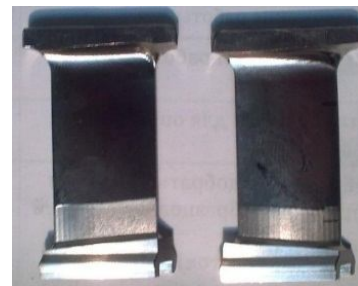
Рис. 7. Заготовки лопаток КВД после высокоскоростного фрезерования пера
