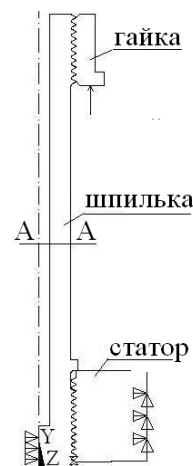
Рис. 6. Схема фланцевого соединения
