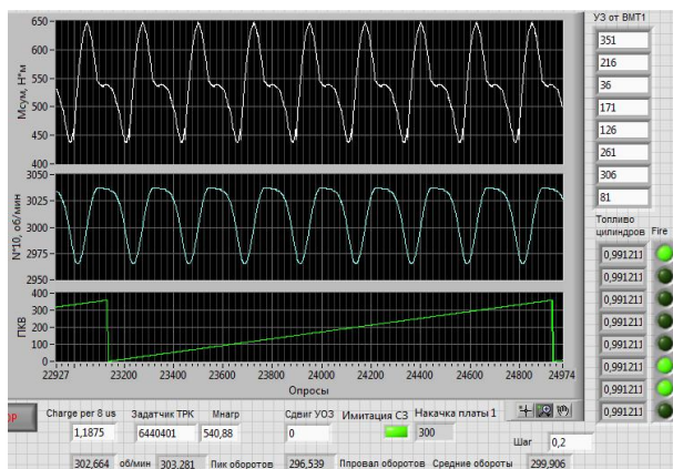
Рис. 14. Осциллограммы крутящего момента и частоты вращения коленчатого вала ГМК в процессе имитации
