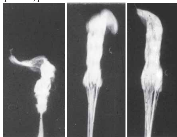
Рис. 2. Флагирующие вершины купола большого парашюта на подготовительном этапе
