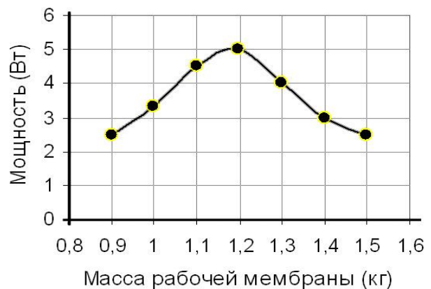
Рис. 4. Зависимость мощности двигателя от массы рабочей мембраны
