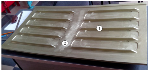
Рис. 1. Панель фюзеляжа двойной кривизны со сложной внутренней гравюрой: 1 – разрезные ребра; 2 – местные утолщения
