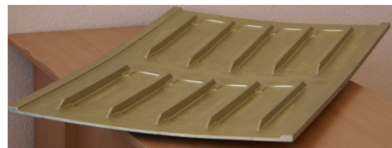
Рис. 6. Панель двойной кривизны со сложной внутренней гравюрой: а – твердотельная модель заготовки панели с плоским полотном; б – панель, отформованная методом местного изгиба с разводкой
