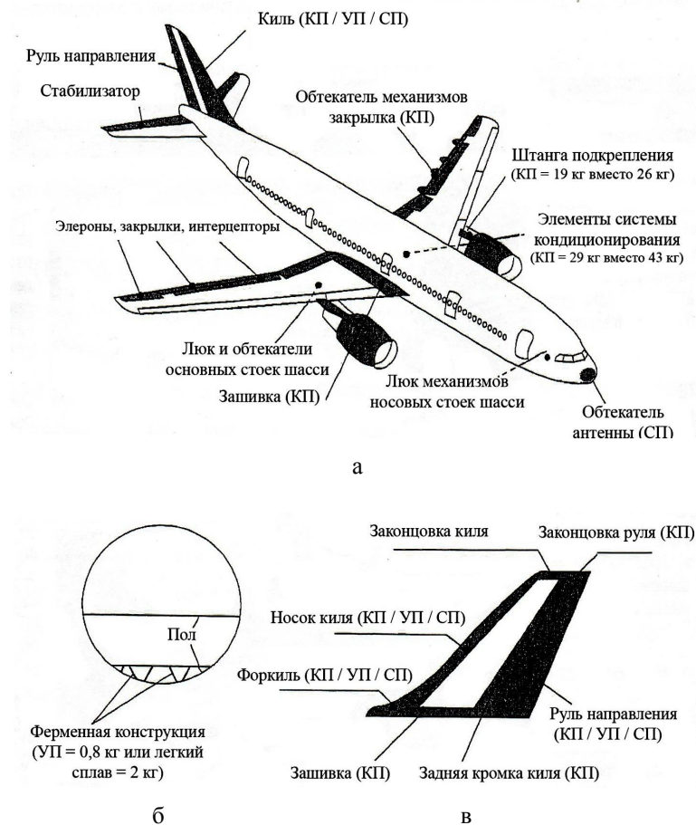
Рис. 4. Применение ПКМ на самолете А-310 [32]: а – самолет в целом; б – пол; в – киль (УП – углепластик, КП – кевларопластик, СП – стеклопластик)
