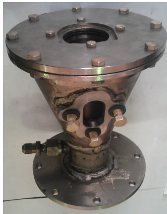
Рис. 2. Принципиальная схема стенда. Фото ресивера
