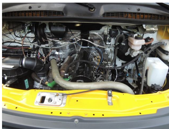
Рис. 3. Двигатель 4ДТНА1 в подкапотном пространстве автобуса
