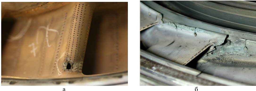
Рис. 6. Прогары лопаток СА ТВД с конвективно-плёночным охлаждением, выполненным из сплава ВКНА: а – на входной кромке; б – на выходной части полок
