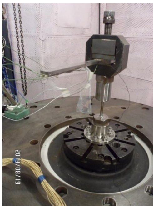
Рис. 2. Устройство для исследования температуропроводности материалов в поле действия виброускорений
