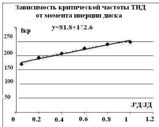
Рис. 4. Изменение критической частоты ротора ГНД при изменении полярного момента инерции диска турбины
