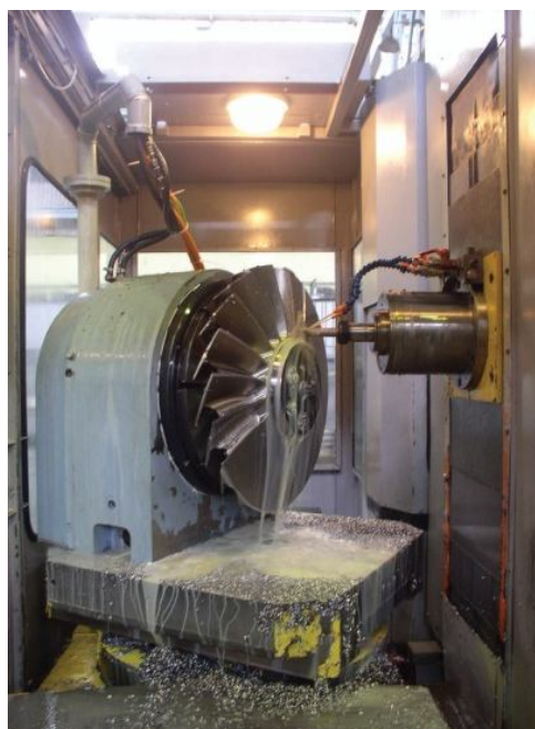
Рис. 10. Рабочая зона модернизированного 5-ти координатного станка ИС-800
