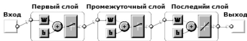
Рис. 2. Структура однонаправленной НС
