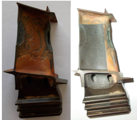
Рис. 4. Следы высокотемпературной коррозии и результат её удаления с поверхности лопатки турбины лазерным методом
