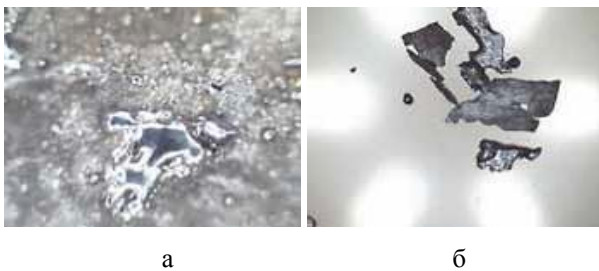
Рис. 3. Металлизированная ржавчина после лазерной обработки поверхности:
