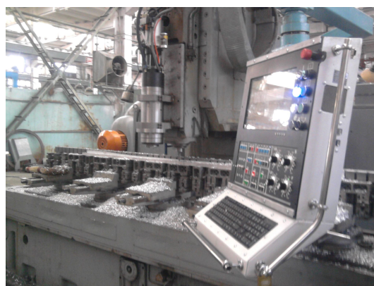
Рис. 7. Модернизированный станок ФП7СМН2 с двухуровневой высокоскоростной системой ЧПУ
