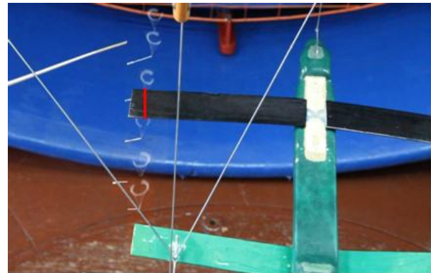
Рис. 2. Вільний вихор переднього крила при кутах ковзання \beta = -5^\circ; 0^\circ; +5^\circ (зверху вниз)
