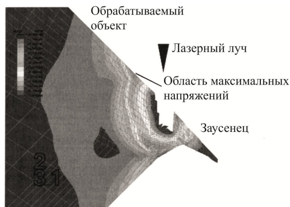
Рис. 8. Поля термических напряжений при лазерной зачистке [25]
