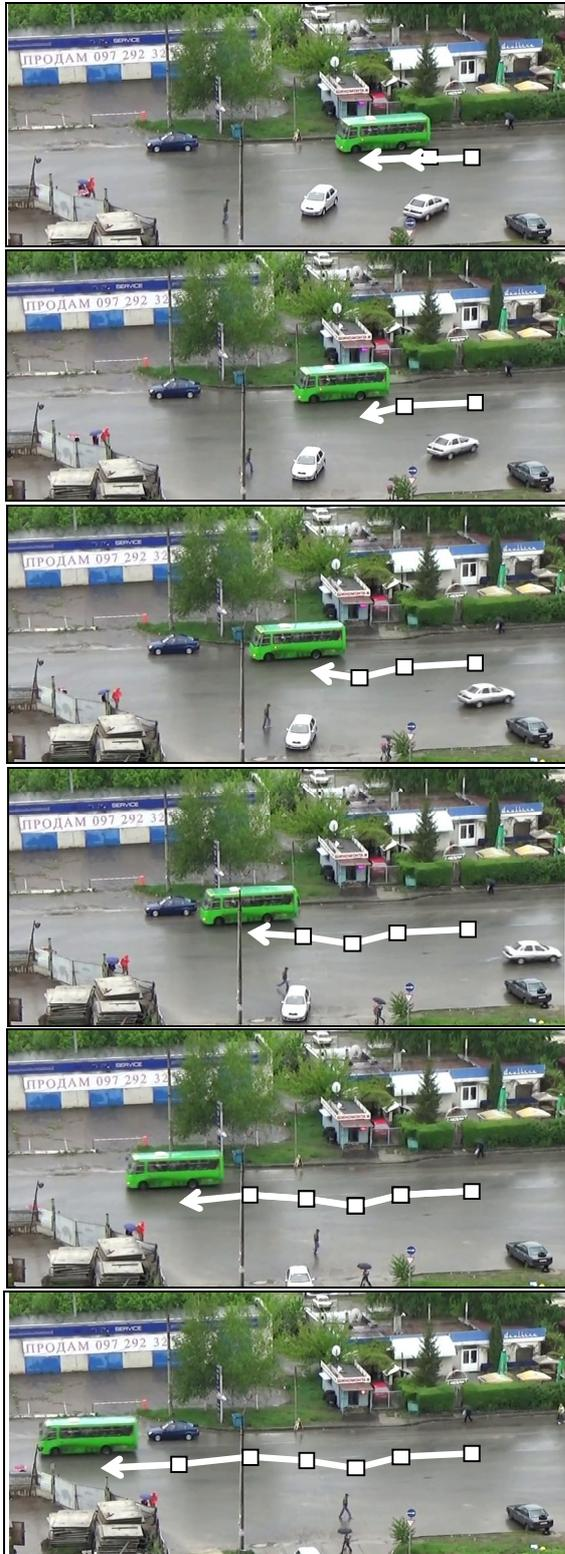
Рис. 11. Траектория движения объекта (а), полученная по результатам обработки снимков (б)
