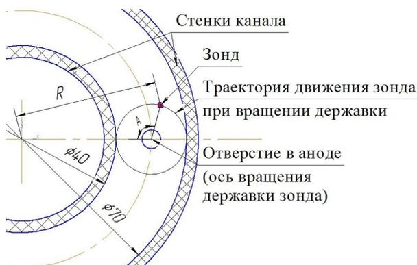
Рис. 8. Схема получения 2й координаты R
