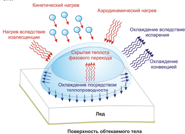
Рис. 5. Схема тепловых потоков при затвердевании капли воды на поверхности тела
