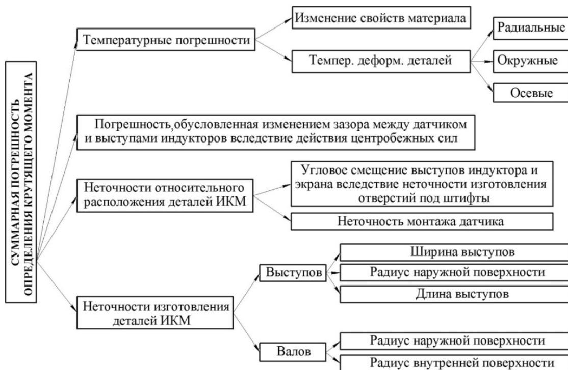
Рис. 5. Структура погрешности определения крутящего момента
