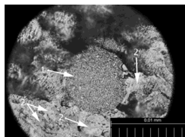
Рис. 4. Структура травленого плазменного покрытия из порошка сплава ХТН23, полученного в работе [11]: 1 – не расплавившаяся порошинка; 2 – полностью расплавившиеся и вновь закристаллизовавшиеся с большой скоростью охлаждения на подложке порошинки
