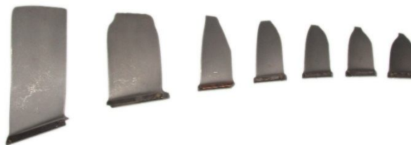
Рис. 1. Характер предельного износа рабочих лопаток по ступеням со 2-й по 8-ю (наработка 128 ч.) [3]
