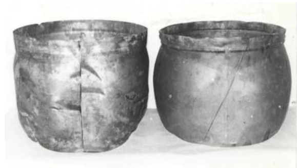
Рис. 2. Деталь с прямым и наклонным сварным швом
