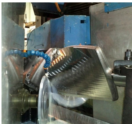
Рис. 9. Фрезерование пера лопатки одновременно с двух сторон на станке 4ФСЛ-8П
