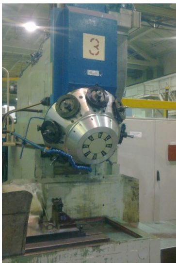
Рис. 11. Модернизированный станок с ЧПУ ФП-17, оснащённый системой ЧПУ WL-4M
