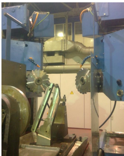
Рис. 8. Подготовка обработки пера лопатки на станке 4ФСЛ-8П
