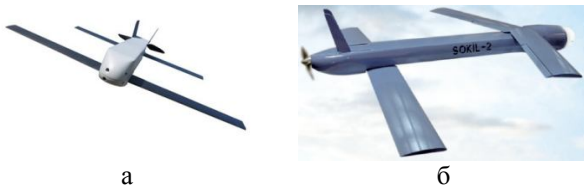
Рис. 1. БПЛА контейнерного старту: а – «Switchblade», б – «Сокіл-2»
