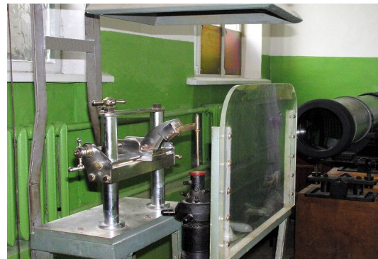
Рис. 4. Учебная сверхзвуковая аэродинамическая труба Т-7
