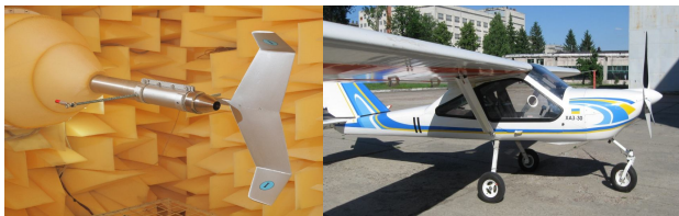
Рис. 20. Исследование акустических характеристик хвостового оперения самолета ХА3 - 30
