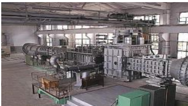
Рис. 6. Сверхзвуковая аэродинамическая труба Т-6
