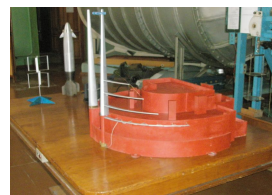
Рис. 18. Аэродинамические исследования модели Одесского Национального оперного театра
