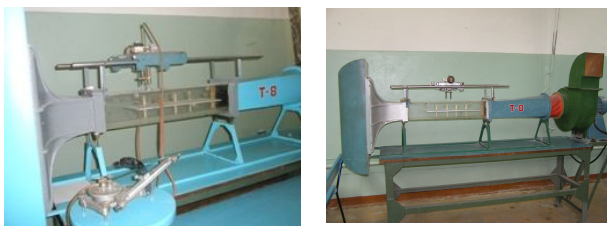
Рис. 2. Учебная аэродинамическая труба Т-8 для определения параметров пограничного слоя
