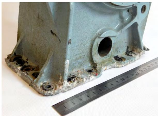
Рис. 4. Коррозия корпуса агрегата из магниевого сплава
