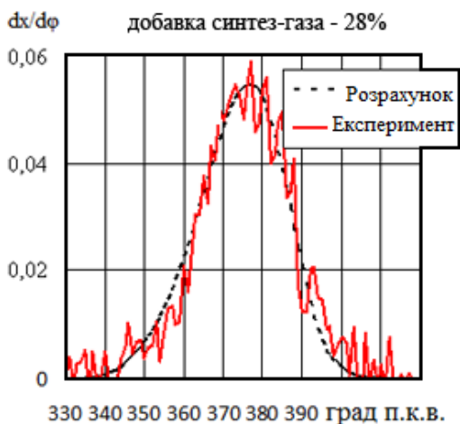
Рис. 1. Індикаторна діаграма двигуна 2Ч 7,2/6 при різних добувках синтез-газу до бензину: 1– бензин; 2, 3, 4 – добувка синтез-газу 28%, 32% і 64% відповідно
