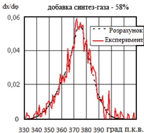
Рис. 2. Розрахункові і експериментальні характеристики тепловиділення при роботі двигуна 2Ч 7,2/6 на бензині з добувками синтез-газу
