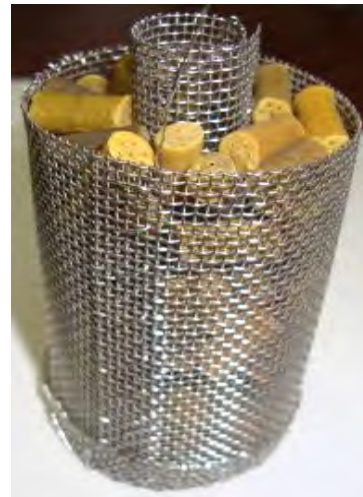
Рис. 4. Заряд с порохом марки 12/7ВА
