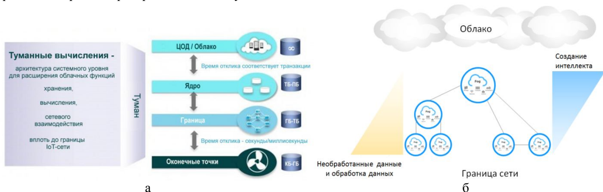
Рис. 6. «Туманные вычисления» в иерархической многоуровневой модели вычислений IoT
